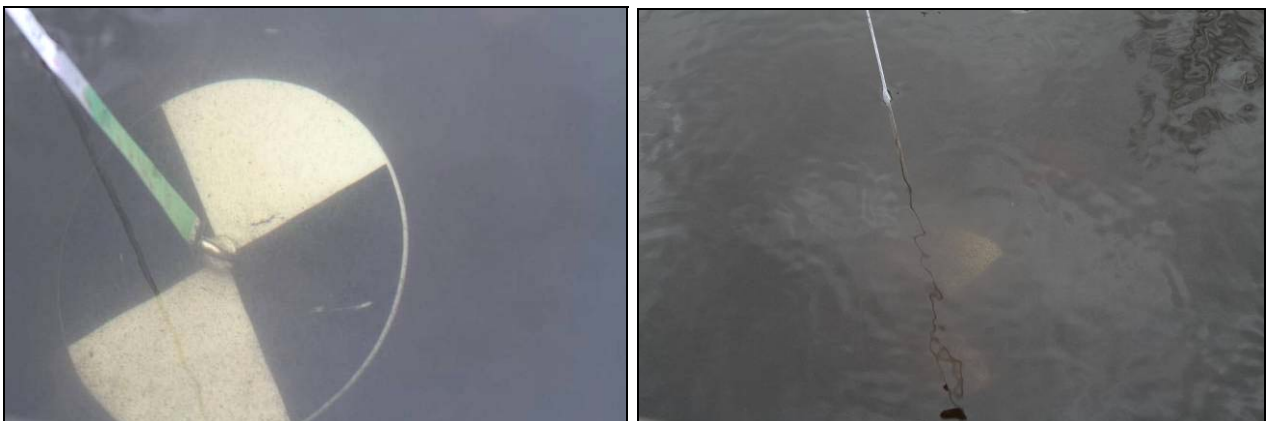
Figura 8 disco di Secchi in prossimità della superficie e immerso in acqua
