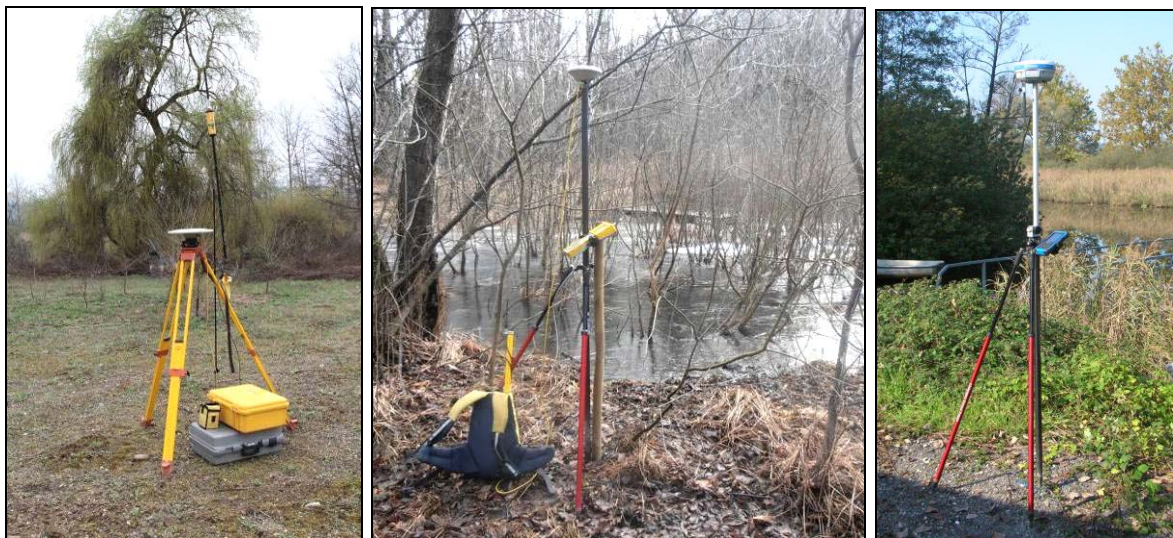
Figura 6 base e ricevitore gps (Trimble e Stonex)
