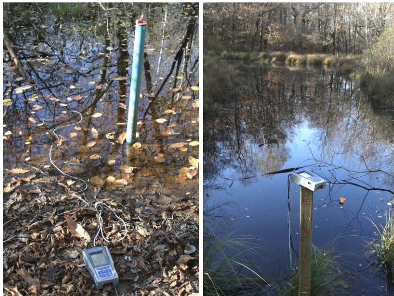
Figura 8 misure chimico-fisiche in corrispondenza del piezometro e della passerella
