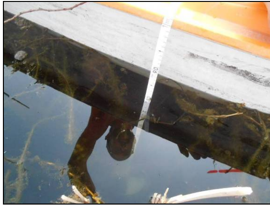
Figura 8 operazioni di misura con disco di Secchi installato su una cordella centimetrata
