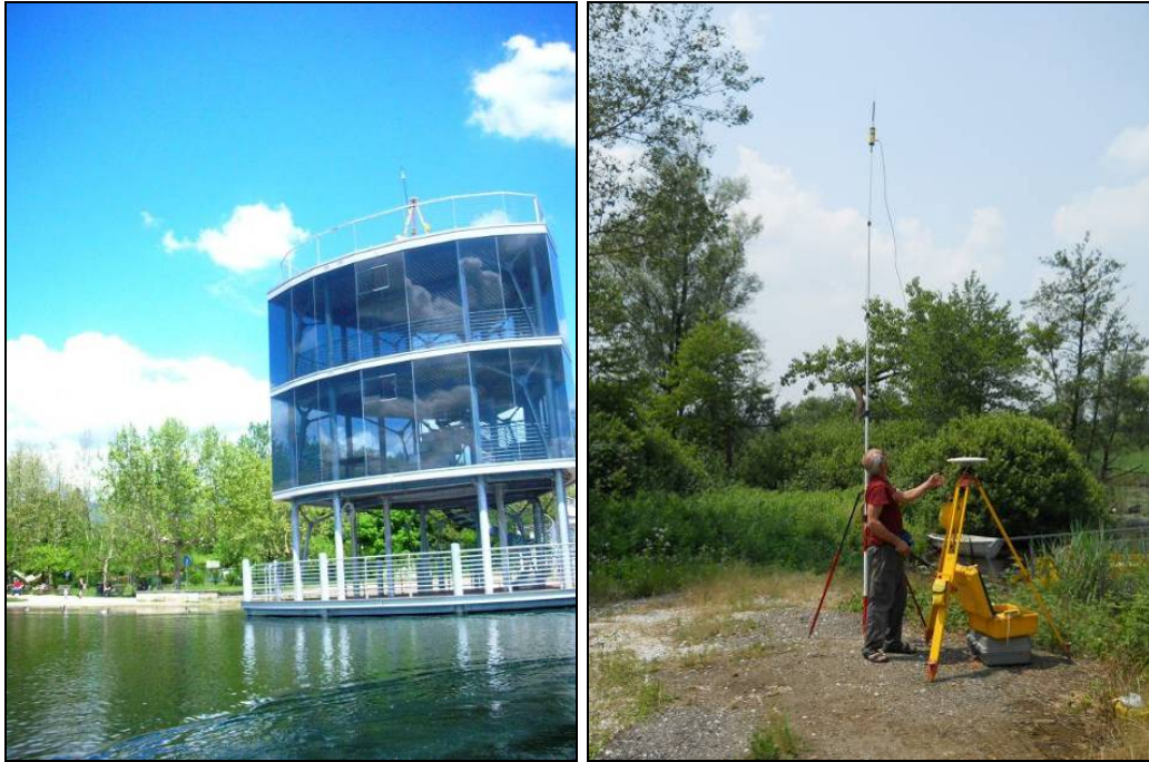
Figura 10 base montata sulla torretta di avvistamento e utilizzo dell'antenna da 5 m
