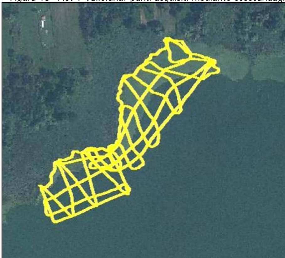
Figura 19 Plot 2-3 Schiranna-Bobbiate: punti acquisiti mediante ecoscandaglio
