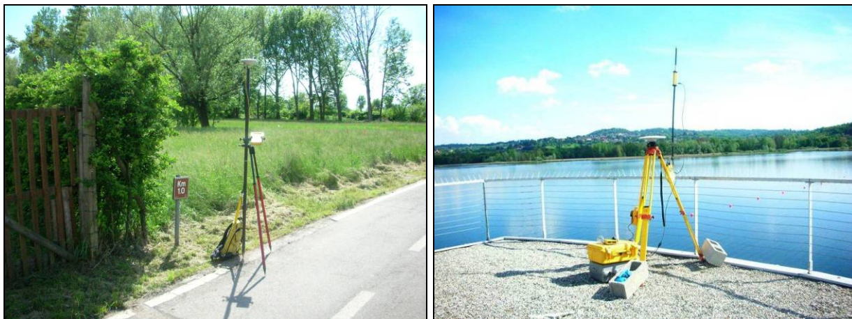
Figura 9 acquisizione di un punto fisso sul lungolago (V23) e base gps montata su una piattaforma sul lago di Varese
