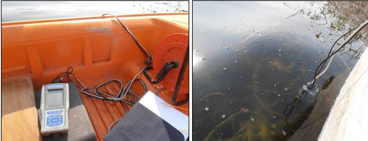
Figura 3 sonda multiparametrica utilizzata per le misure chimico-fisiche sul lago
