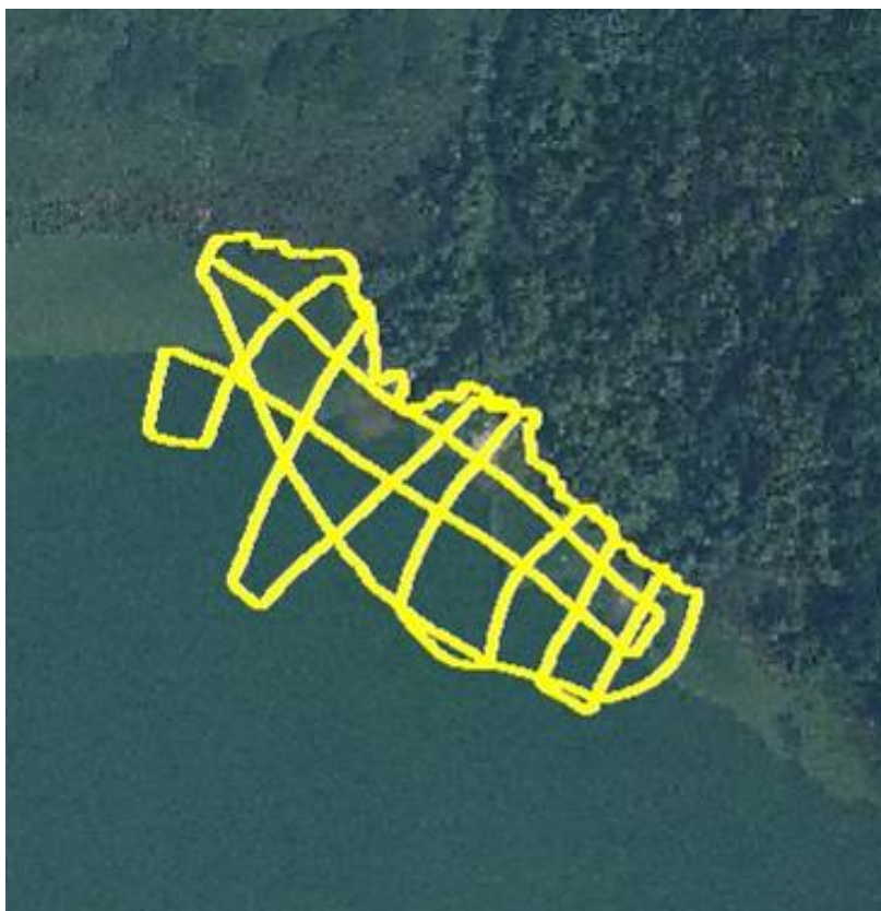
Figura 18 Plot 1-Valleluna: punti acquisiti mediante ecoscandaglio
