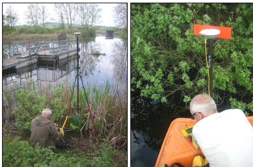
Figura 14 acquisizione posizione piezometro e palo segnalatore in palude Brabbia
