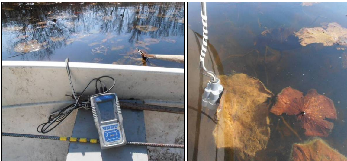
Figura 1 sonda multiparametrica utilizzata per le misure chimico-fisiche
